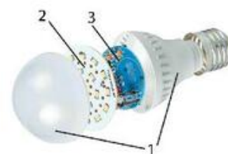
Hình 9.4. Cấu tạo của đèn LED
