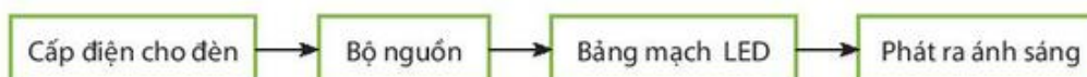
Hình 9.5. Sơ đồ khối mô tả nguyên lí làm việc của đèn LED
